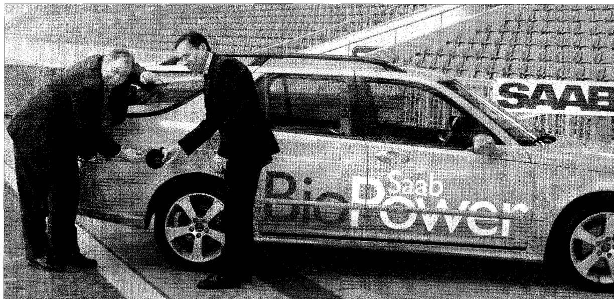
Pierre Schaller, Direktor Alcosuisse, und Christoph Bleile, PR-Manager bei GM Schweiz, füllen E85 in den Tank. Dieser Saab 9-5 BioPower ist ein sogenanntes Flexible-Fuel-Vehicle (FFV) und fährt sowohl mit Bioethanol als auch mit bleifreiem Benzin. (Bild: röt)
