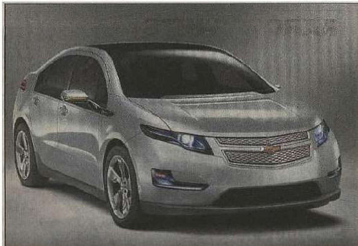
Der Chevrolet Volt kann in weniger als drei Stunden an einer Standard-Haushaltsteckdose aufgeladen werden.
